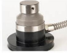
千分级高精度对刀仪,重复精度为0.002mm, IP68防护等级,300万次触点寿命,304不锈钢线缆保护软管。
